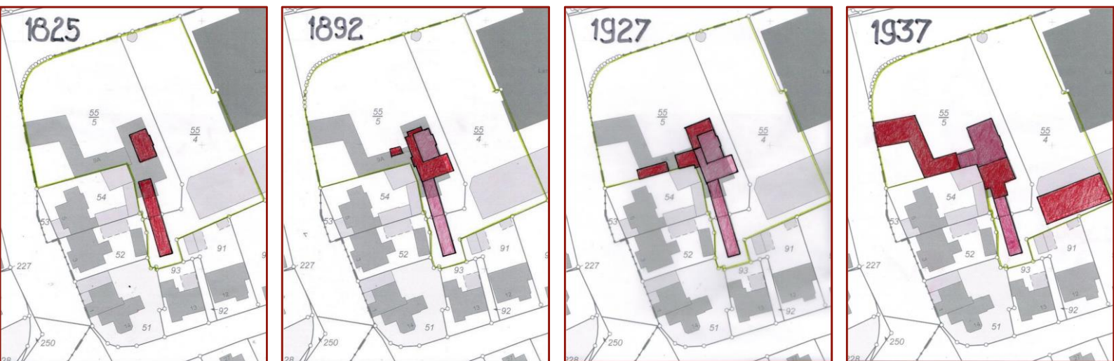
Skizzen zur baulichen Entwicklung des Geländes der Goslarer Gartengesellschaft auf Grundlage der aktuellen Katasterkarte des Landesamtes für Geoinformation und Landesvermessung LGLN – Katasteramt Goslar – Der heutige Baubestand ist grau eingezeichnet. Rot dargestellt sind die Bauten, die bis zum jeweiligen Bezugsjahr neu errichtet bzw. umgebaut wurden, rosa die bereits aus den vergangenen Zeiträumen vorhandenen Gebäude (Grafik: Piegsa)
