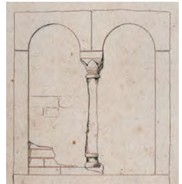
Abb. 162: Biforium im heute verdeckten und verkleideten Nordgiebel der Kemenate (Mithoff 1857, Tafel XXXI).
